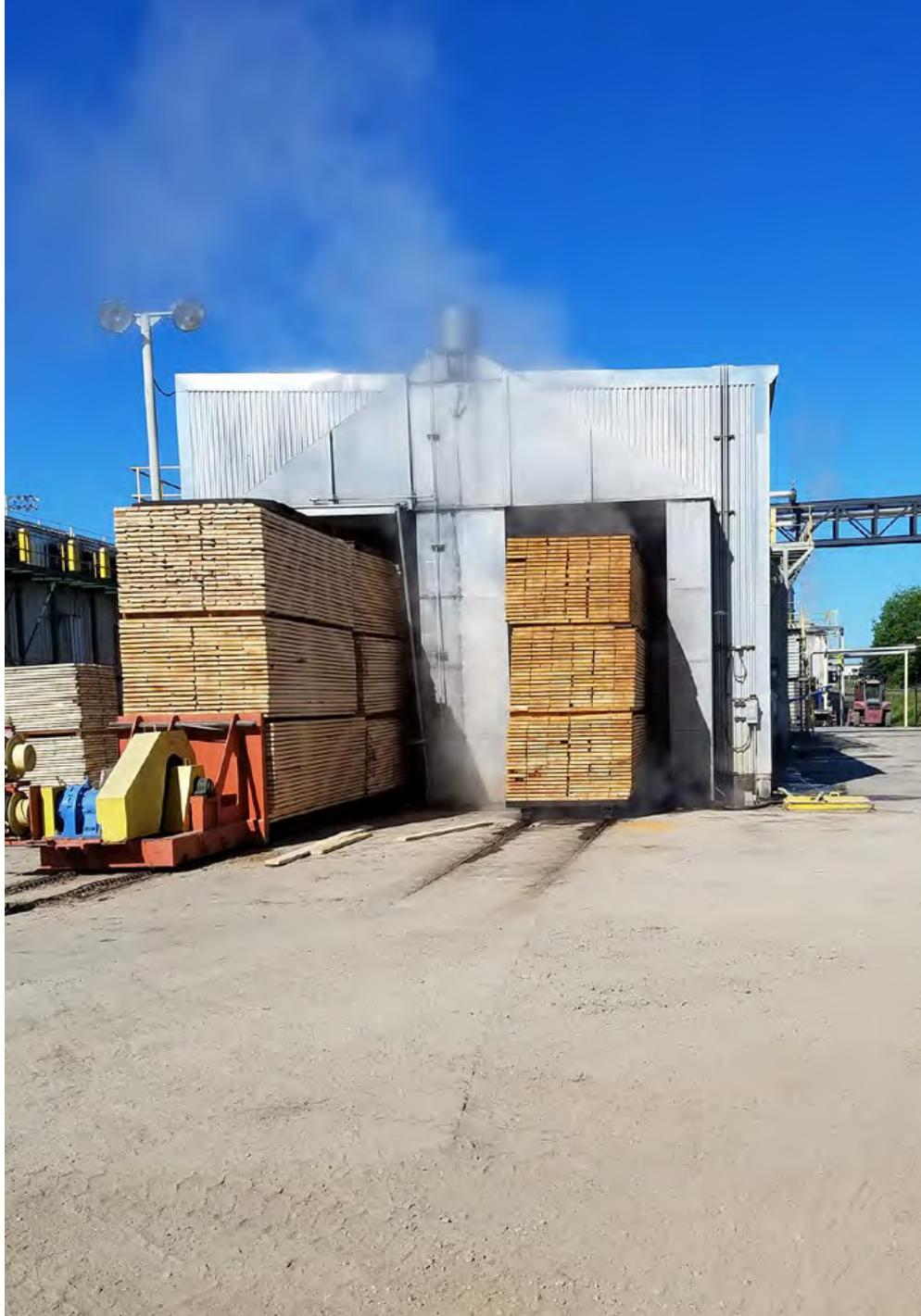
En alimentant la majorité de nos séchoirs avec des résidus de bois, nous sommes en mesure d'éviter les combustibles fossiles et d'augmenter notre résilience énergétique pour la partie la plus énergivore de notre processus de fabrication.
