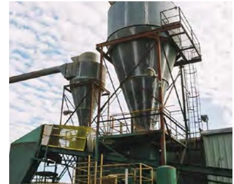
Les filtres cyclones provoquent une rotation de l'air, ce qui permet de capter les poussières et les grosses particules pour les retirer de l'air.
