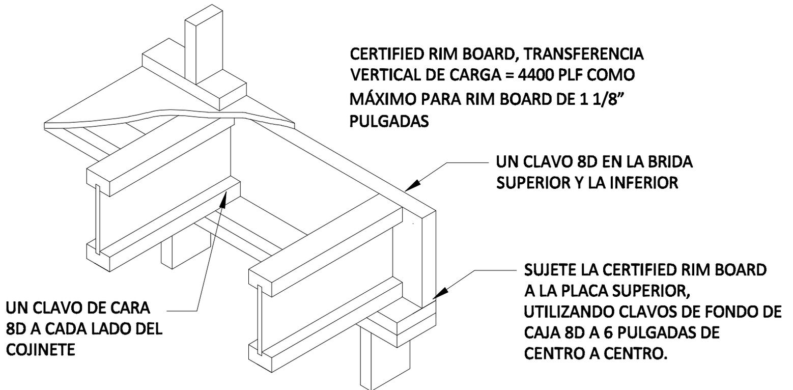
PARA EVITAR PARTIR LA BRIDA, COMIENZE A METER CLAVOS AL MENOS A 1 1/2 PULGADAS DEL EXTREMO DE LA VIGUETA P3 JOIST. SE PODRÁN CLAVAR LOS CLAVOS EN ÁNGULO PARA NO PARTIR LA PLACA DE APOYO.
