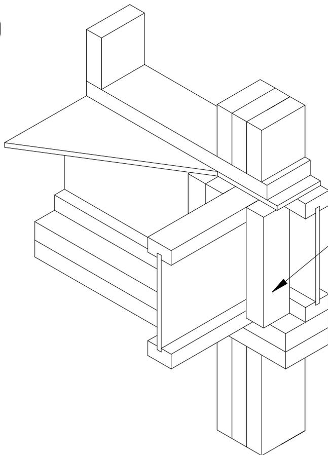
**BLOQUE SÓLIDO DE TODOS LOS POSTES DESDE ARRIBA HASTA EL COJINETE INFERIOR. INSTALE BLOQUES DE APLASTAMIENTO SEGÚN 2d. HAGA COINCIDIR LA CANTIDAD DE BLOQUES INFERIORES CON EL POSTE SUPERIOR.**
