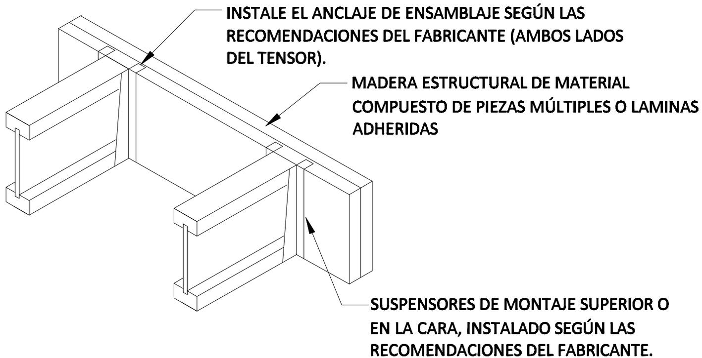
**NOTA:** A MENOS QUE LOS LADOS DEL SUSPENSORES SOPORTEN LATERALMENTE LA BRIDA SUPERIOR, SE DEBERÁN UTILIZAR TENSORES DE COJINETES (VEA LA FIGURA 1).
