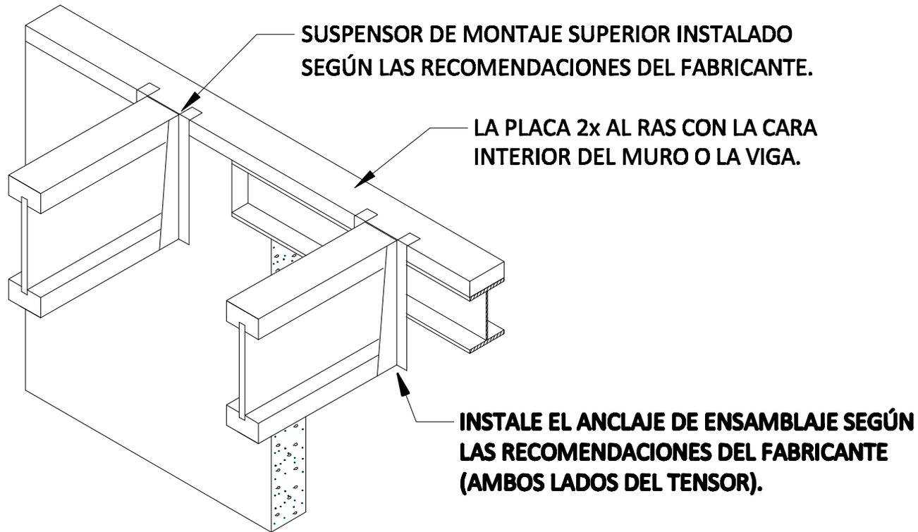
**NOTA: A MENOS QUE LOS LADOS DEL SUSPENSOR SOPORTEN LATERALMENTE LA BRIDA SUPERIOR, SE DEBERÁN UTILIZAR TENSORES DE COJINETES (VEA LA FIGURA 1).**
